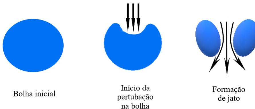
Figura 2.3: Fenômeno da cavitação - desenho próprio
